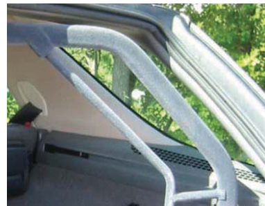
Tubagem revestida com tecidos.
